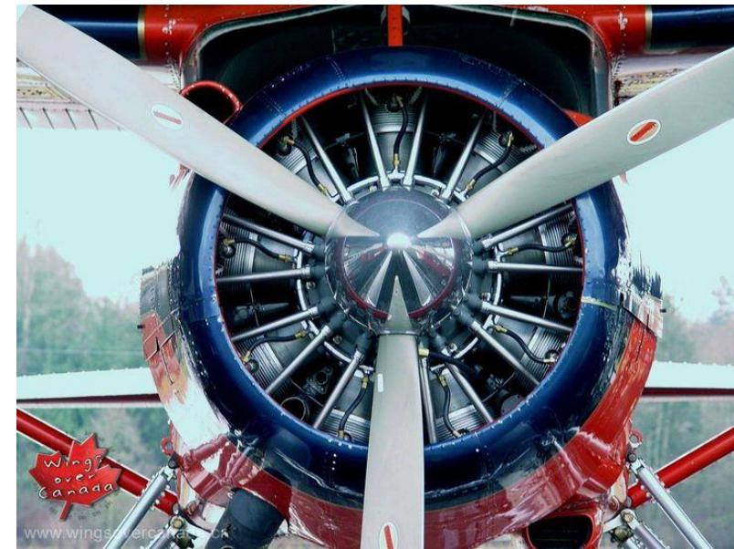
Une photo d'un moteur radial à 9 cylindres :
